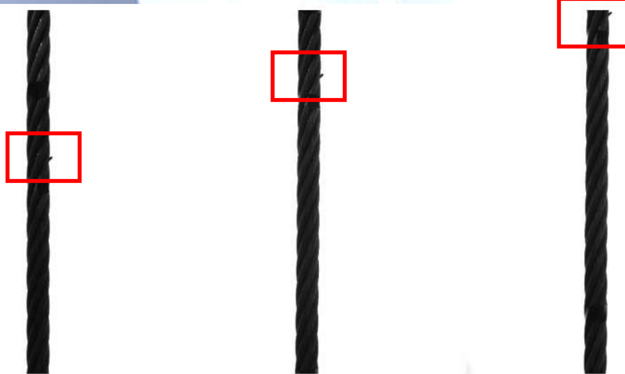
RopeInspector™ цифровая фотокамера отображает дефекты
