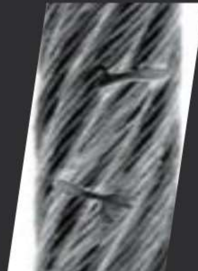
Зазубрины и ударные повреждения
