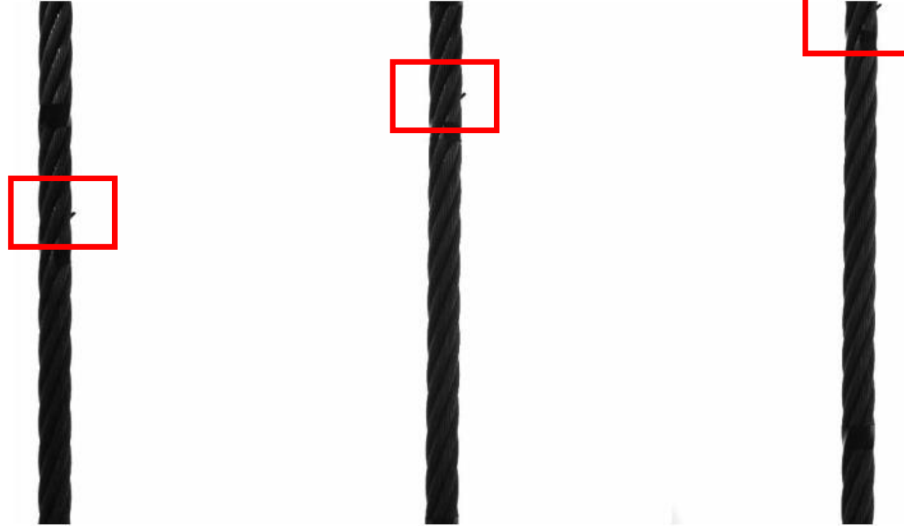
RopeInspector™ цифровая фотокамера отображает дефекты
