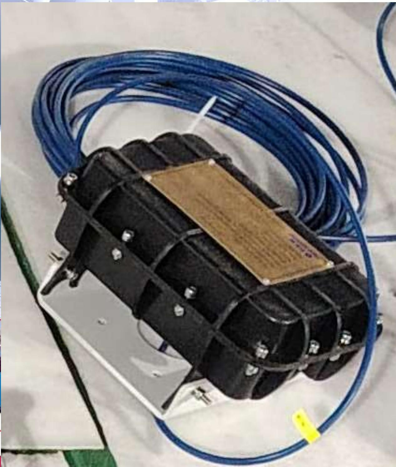
**2. Считыватель RFID метки.**
